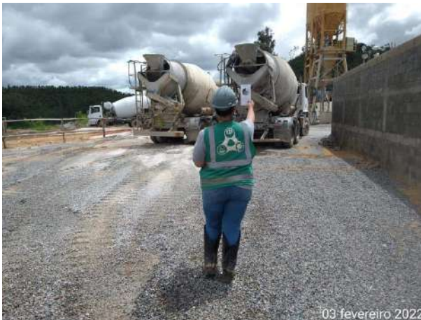
Foto 403 – Medição de fumaça preta em caminhão betoneira. (Data:03/02/2022)
