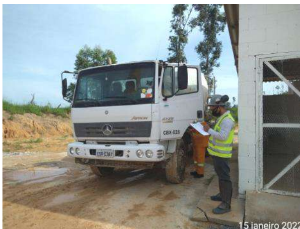
Foto 169 – Inspeção de caminhão betoneira na usina de concreto. (Data:15/01/2022)
