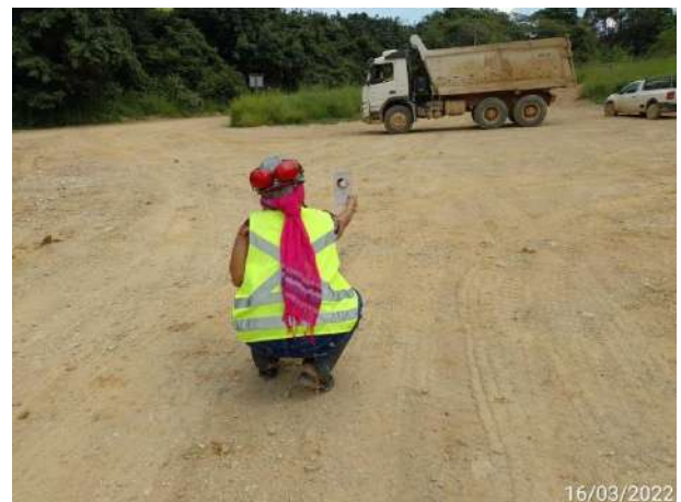
Foto 412 – Medição de fumaça preta em caminhão basculante. (Data:16/03/2022)
