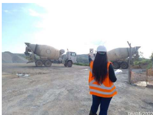
Foto 415 – Medição de fumaça preta em caminhão betoneira. (Data:06/04/2022)
