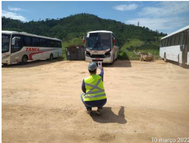
Foto 407 – Medição de fumaça preta em ônibus. (Data:10/03/2022)
